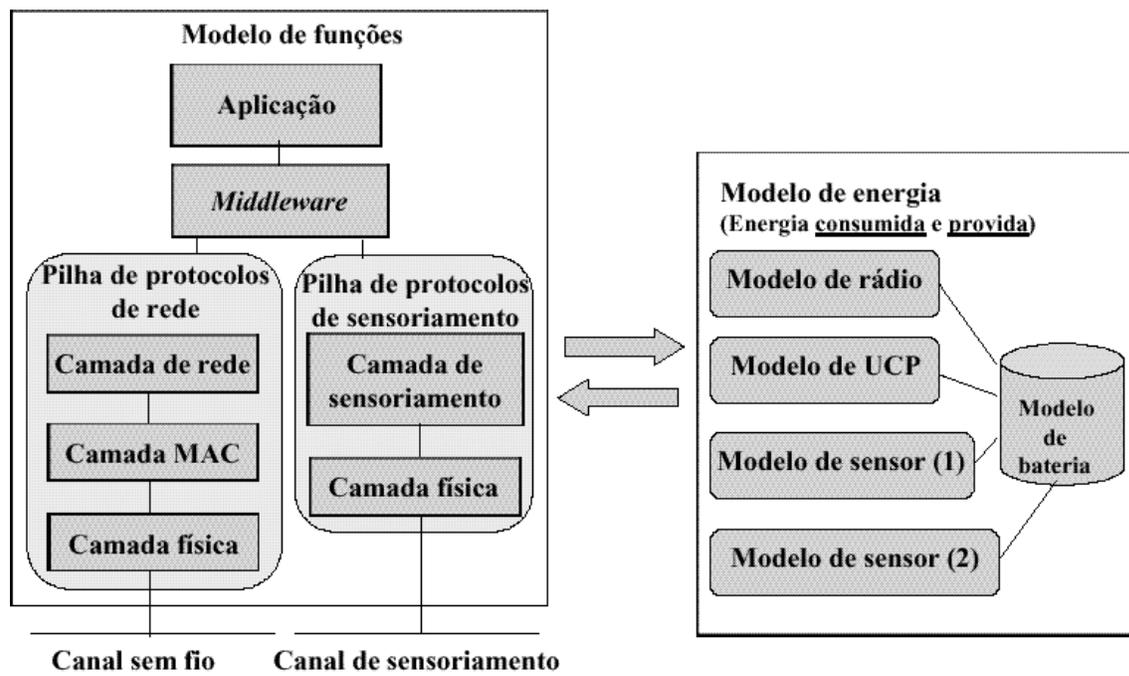
Figura 5.27: Modelo proposto de microsensor do projeto SensorSim.
