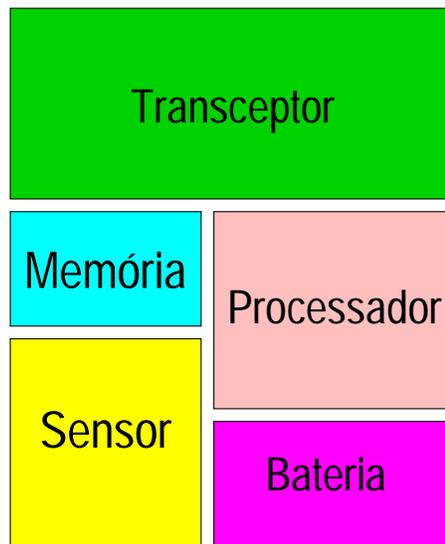
Figura 5.10: Hardware básico de um nodo sensor.
