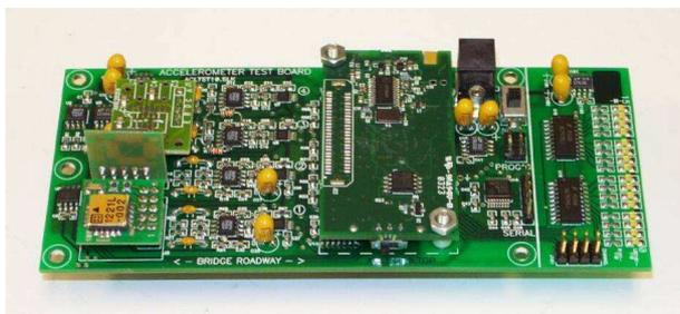
**Figura 2.10:** Placa de sensor desenvolvida com acelerômetro.
